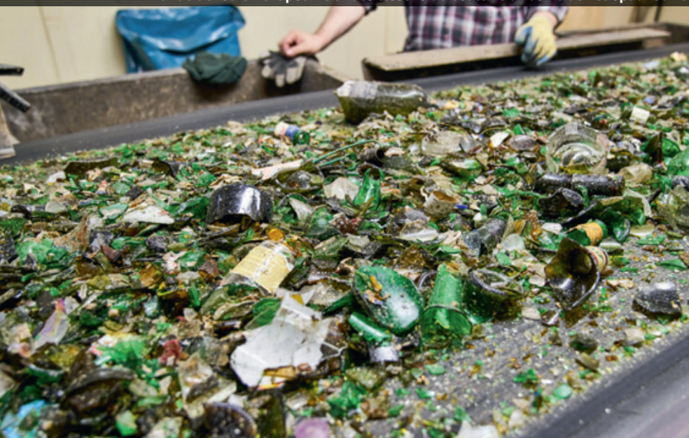
Bande de roulement pour le tri des tessons de bouteille à l'usine de Vetropack Saint-Prex. Vetropack
